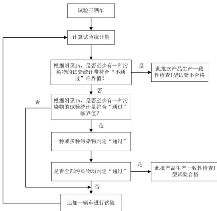
图2 生产一致性检查 I 型试验流程图
