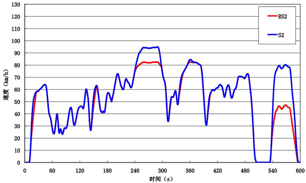
图 CC. 2 试验循环第 2 阶段工况图
