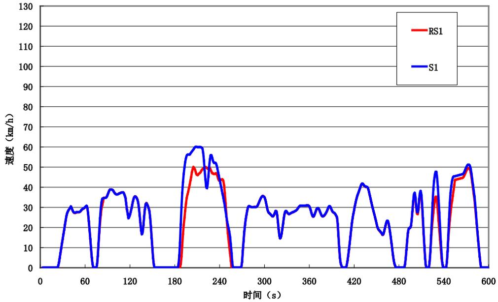
图 CC. 1 试验循环第 1 阶段工况图
