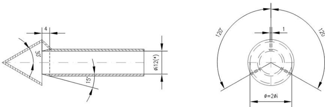
壁厚：1mm 材料：不锈钢(\*) 最小内径
