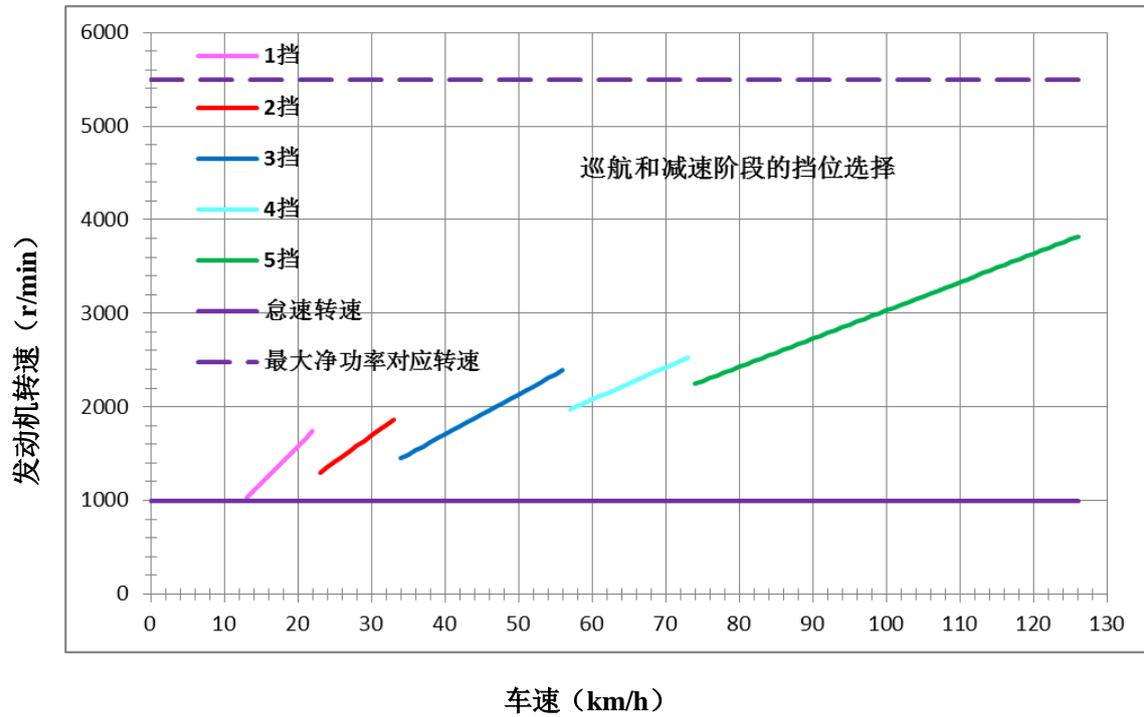
图 CE.2 巡航及减速换挡示例
