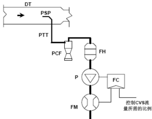
图 CH. 2 颗粒物取样系统示意图
