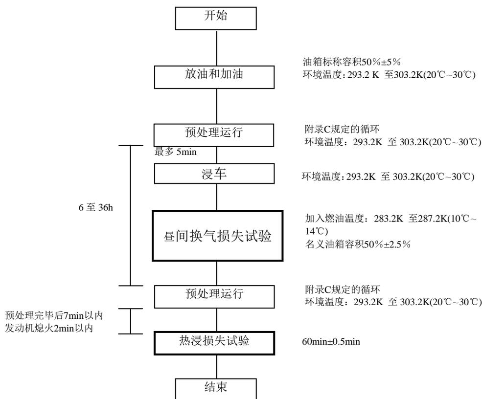
图 E. 1 蒸发污染物排放试验流程
