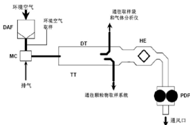
图 CH.4 带有容积泵 (PDP) 的稀释系统
