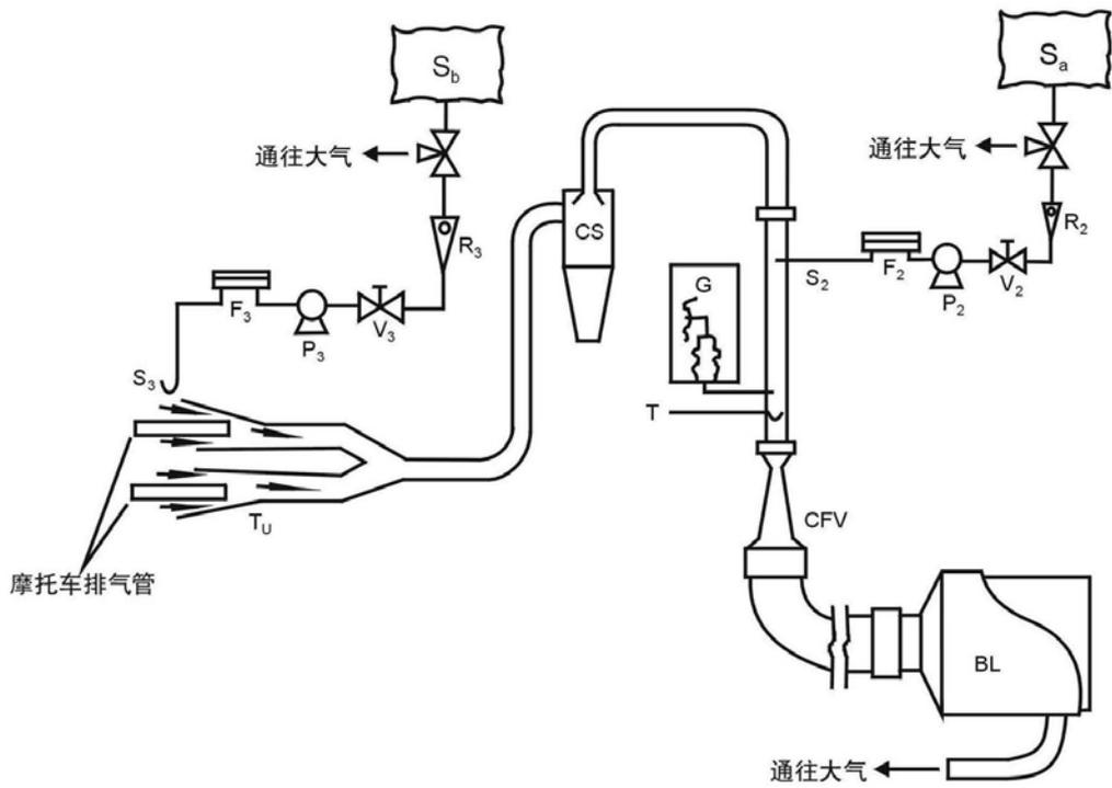
图C.3 排气分析系统示例 2
